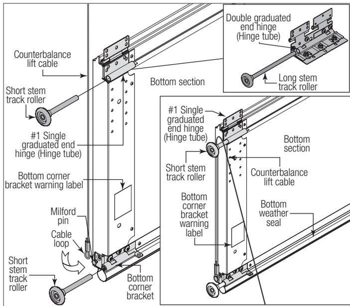
IF THE BOTTOM SECTION WAS SHIMMED TO LEVEL IT, THE VERTICAL TRACK ON THE SHIMMED SIDE MUST BE RAISED THE HEIGHT OF THE SHIM.
